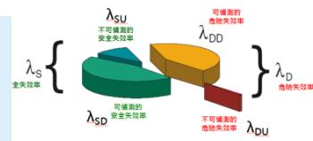
SFF (安全失效分數): 子系統的安全失效率及可偵測危險失效率的總和在子系統全部失效率所占的比例，例如：SFF = 0.9 表示90%的失效故障為安全失效，不會導致安全性喪失
